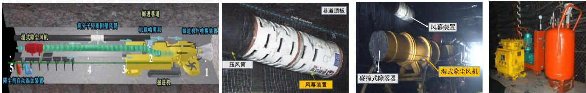
图 1 协同增效控尘装备布置示意图 图 2 风幕装置 图 3 除尘风机 图 4 增润剂添加装置
