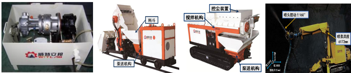
图 7 速凝剂添加装置
