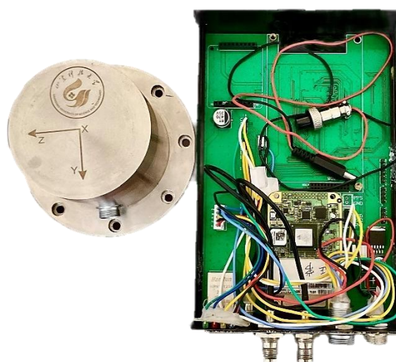
图 2 用于工程机械等大型设备的组合导航系统
