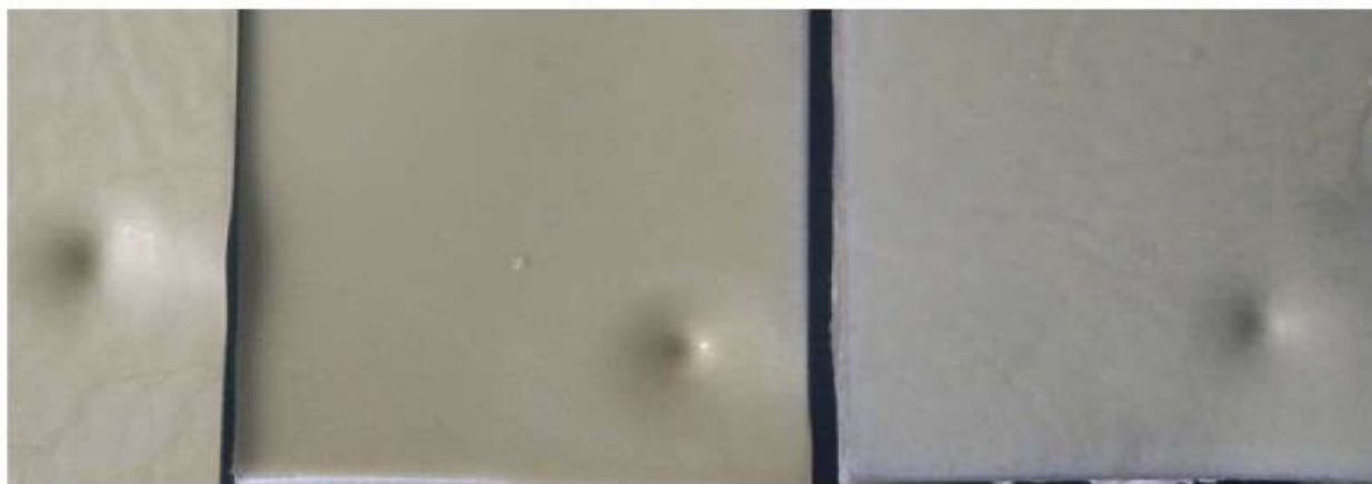
图 3-8 铁板镀锌对涂层抗冲击韧性的影响
