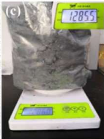
实验室条件下生产出的高品质SiC纳米线的XRD图谱，SEM照片及单炉宏观产量照片
