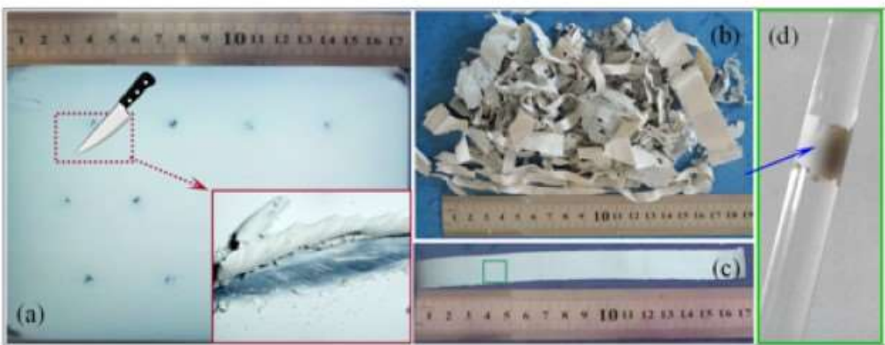
在石墨基片上制备出的超长薄膜状SiC纳米线
