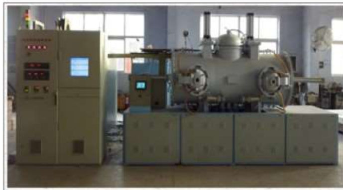
连续式纳米材料可控气氛炉及获批发明专利
