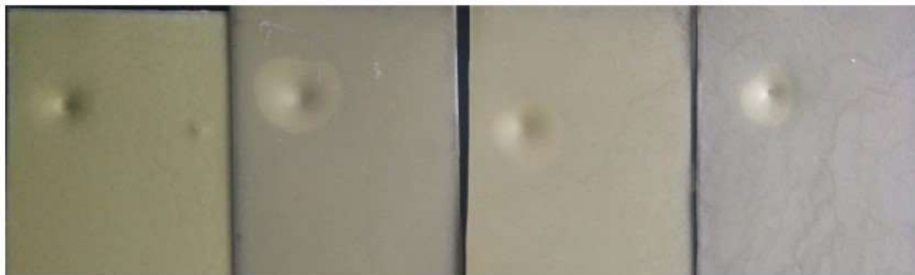
图 3-6 普通铁板底板对涂层抗冲击韧性的影响
